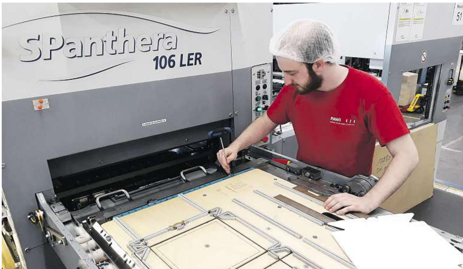
Mit Hilfe der Stanzmaschine schneidet Ismael Brederoo Karton, der später für eine Verpackung benötigt wird, in die gewünschte Form.
